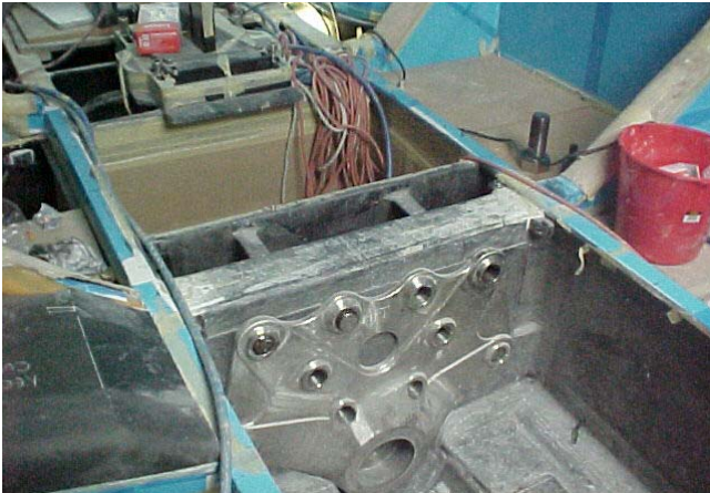
Der Rumpf mit den vorgesehenen Kielverschraubungen
